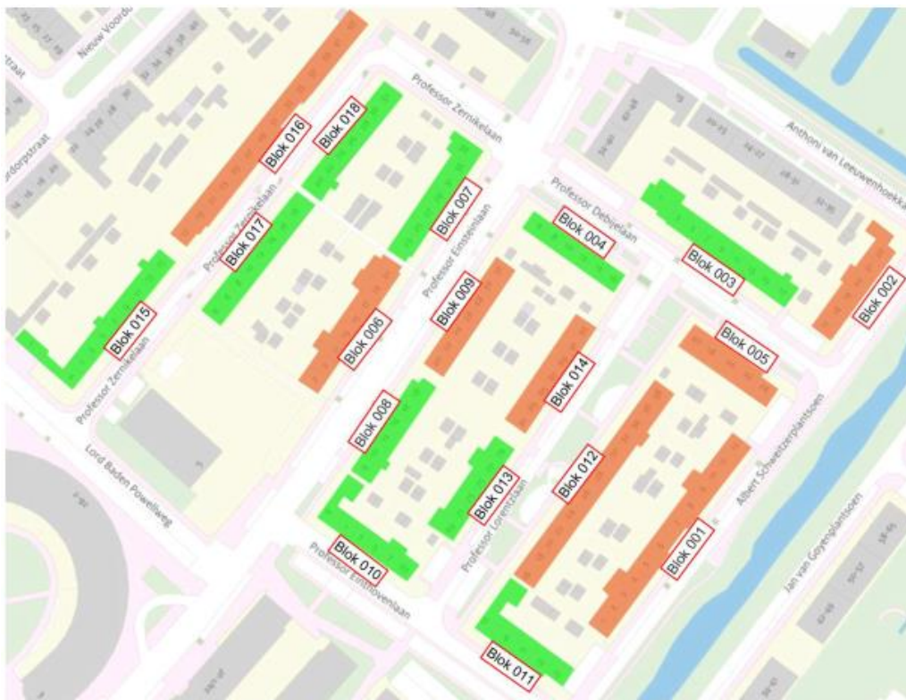
Figuur 7: Overzicht van de gemeten ongelijkmatige zakkingen bij de lintvoegmetingen
